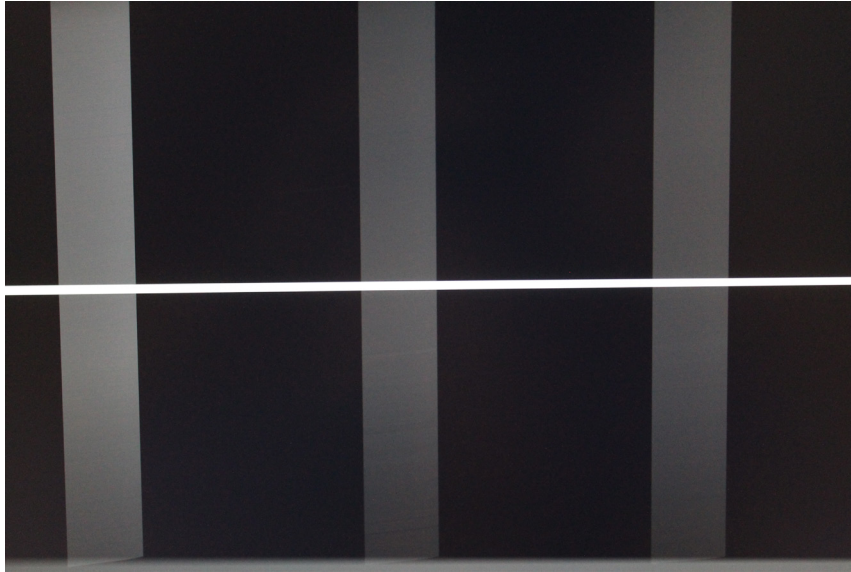
Рис. 3. Пример динамического фотографирования экрана (офисный монитор AOC 23 дюйма) — ШИМ отсутствует
